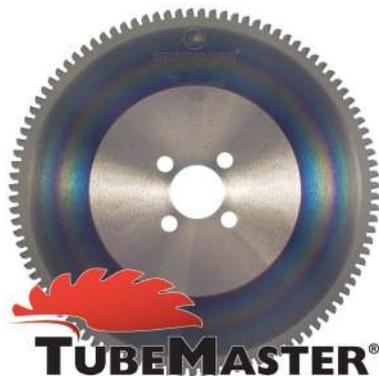
TubeMaster hardmetall-bestückte Metallkreissägeblätter sind speziell für orbital mitlaufende Sägen auf Rohrschweißmaschinen entwickelt worden. Wesentliche Merkmale des TubeMaster Sägeblattes sind bruchfeste Hartmetallzähne, welche durch eine High-Tech-TiAlNbasierte PVD-Beschichtung geschützt sind.
